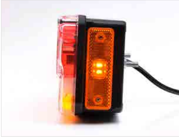
W44 to dodatkowe światło pozycyjne boczne this additional site position light
